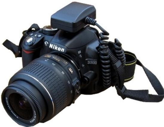
*Kamera mit angebautem Geotagger*
